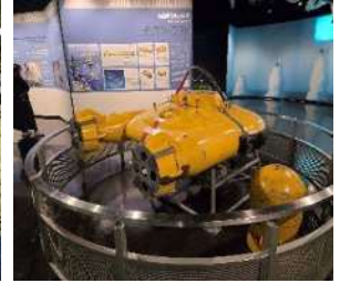
写真-7 初期の機雷探知用 ソーナー
