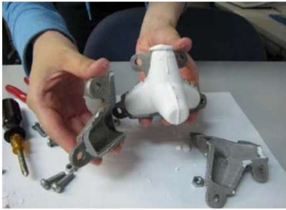
図-1 ミニチュア消波ブロックの工作の様子
