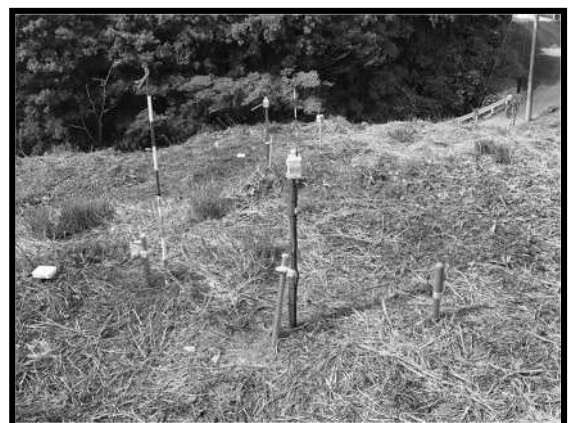
図-3 傾斜計の設置事例
