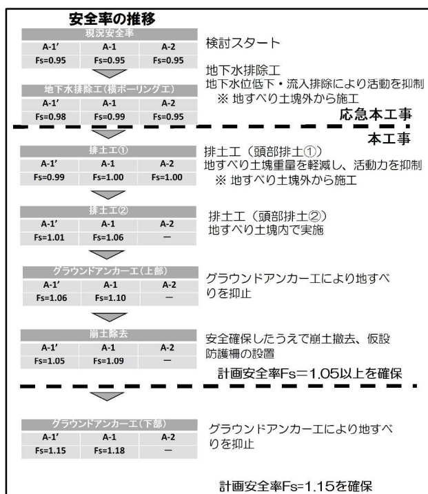
図-6 対策工事のフロー
