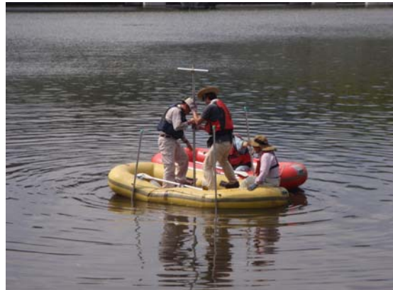
津波堆積物の土試料採取実演
